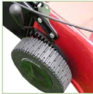
Zentrale Schnitthöhen - Verstellung. Ein Hebel und 4 Räder ändern die Schnitthöhe des Mähdecks.
