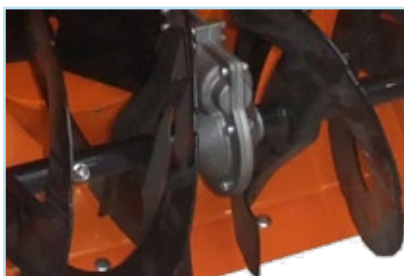
Ein robustes Schneckengetriebe ist das A und O einer guten Schneefräse.
